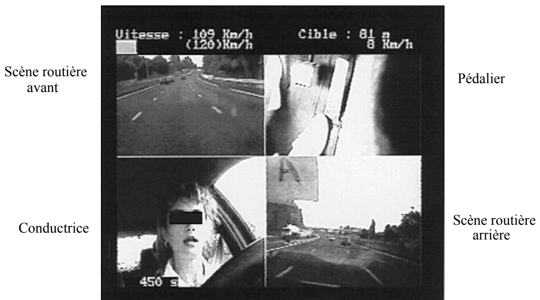
Figure 5.- Enregistrement vidéo en quadra-vision, associé à une acquisition informatique de données numériques
